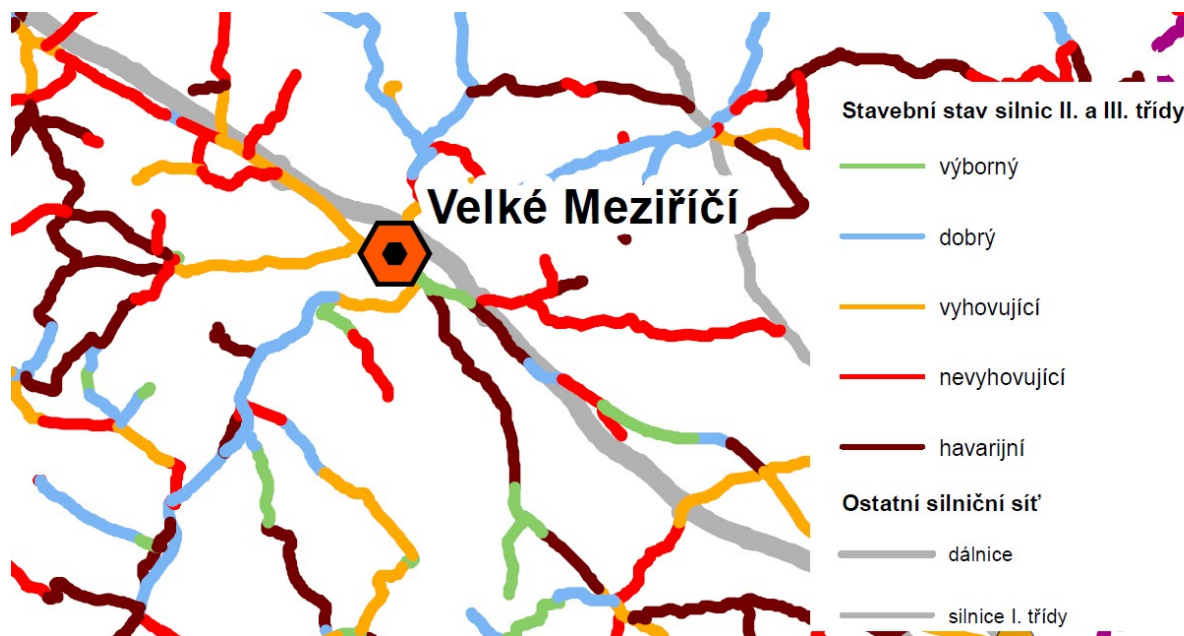
Obrázek 13 Stavebně technický stav silnic II. a III. tř v roce 2017
