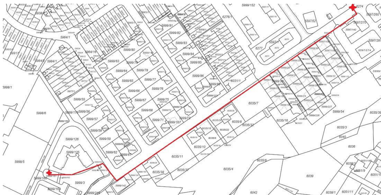
Vedení optické přípojky z kabelové komory ke kamerovému bodu
